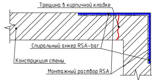
Спецификация материалов на ремонт поврежденного участка стены (расход на 1 м.п. анкера 1.8 кг монтажного состава)
