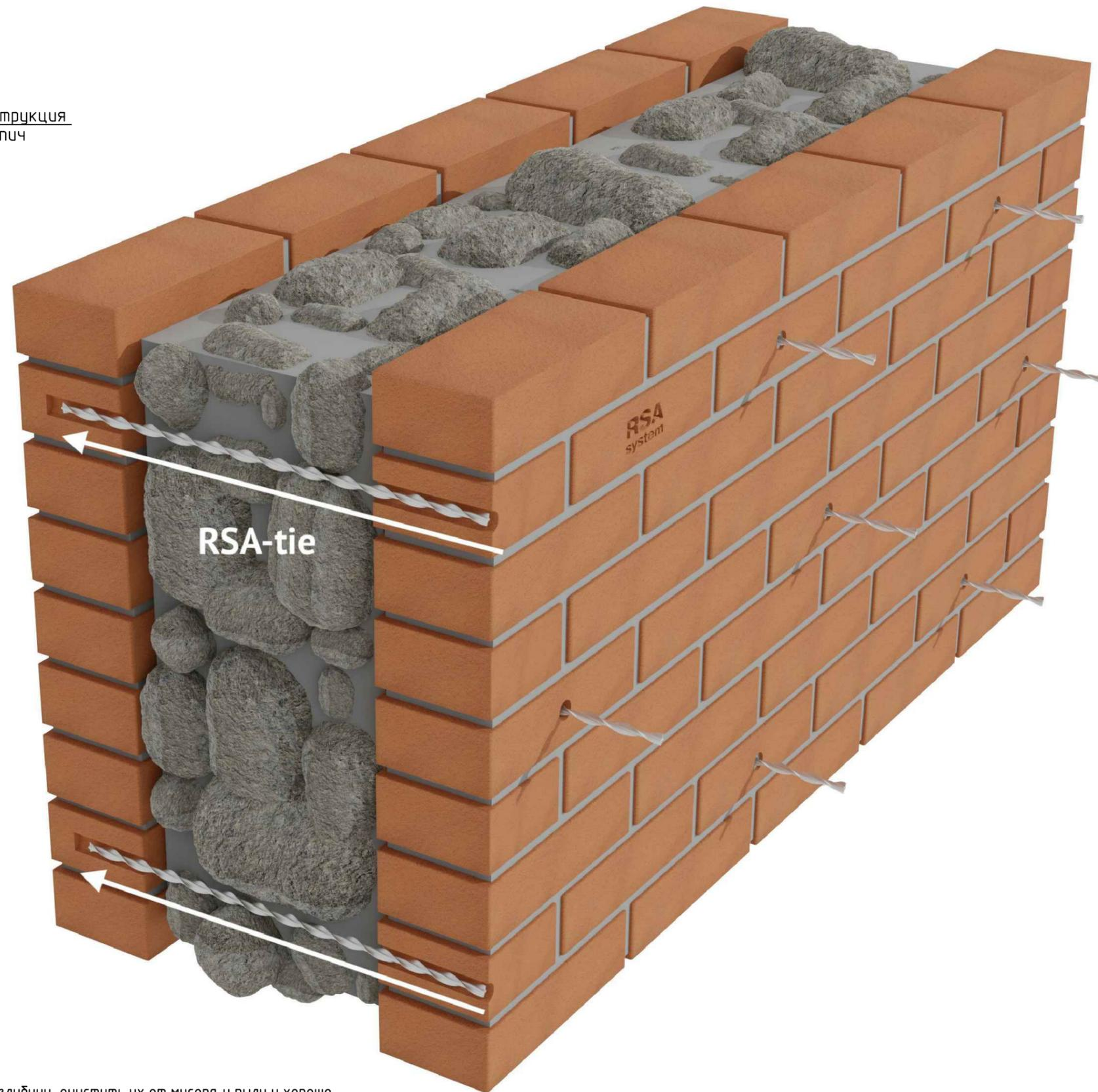
Спецификация материалов на ремонт поврежденного участка стены (расход на 1 м.п. анкера 1.8 кг монтажного состава)
