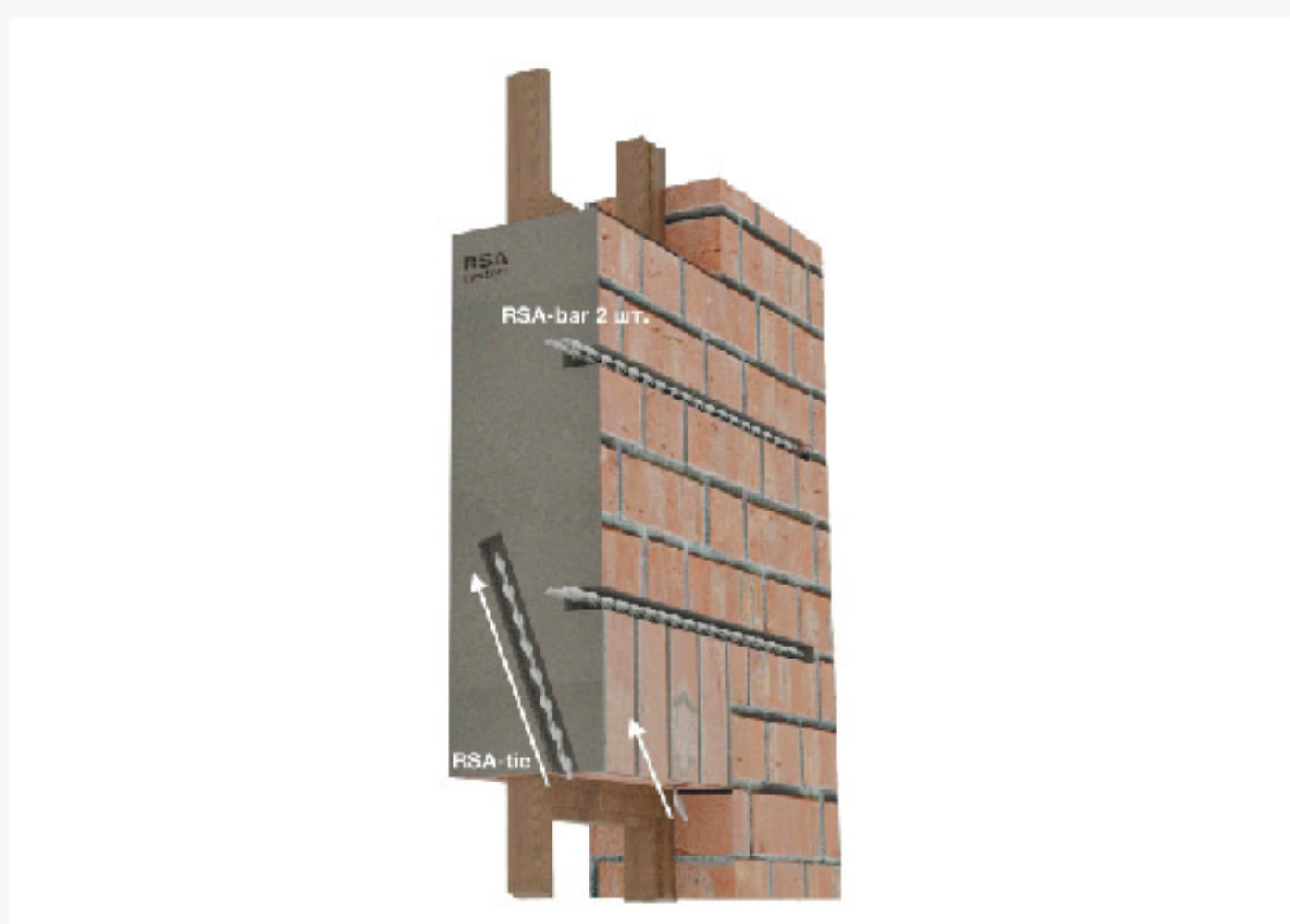
Рис. 9 Ремонт надоконной перемычки вар. 2
